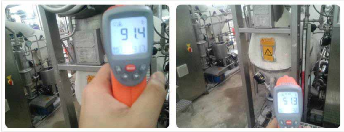
Şekil 6.3. Yüzey Sıcaklığının Yalıtımlı ve Yalıtımsız Olarak Karşılaştırılması
